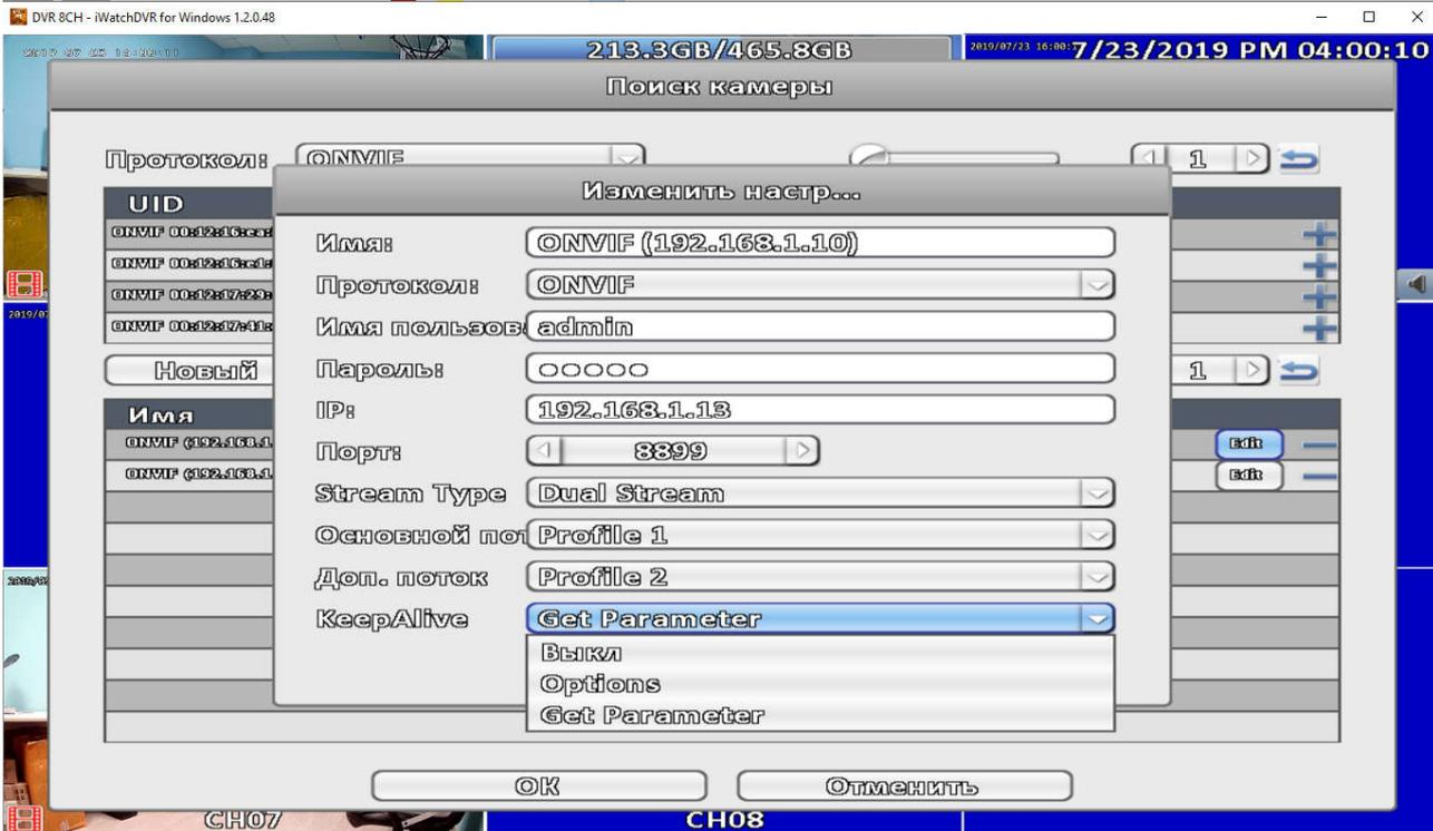
Если в пункте **Keep Alive** оставить выбранным пункт Выкл. Может наблюдаться отключение IP-видеокамеры на 1-2 секунды каждые 2 минуты.
